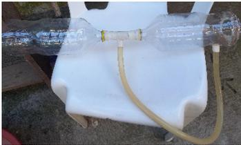
Figura 7. Paso 6. Conectar un tubo transparente a ambos agujeros y pegar el prototipo.
