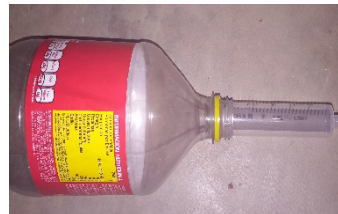
Figura 3. Paso 2. Sacar el tubo de las jeringas y acoplarlo a las botellas.
