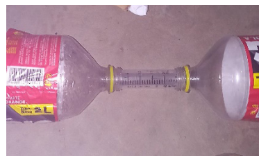
Figura 3. Paso 2. Sacar el tubo de las jeringas y acoplarlo a las botellas.
