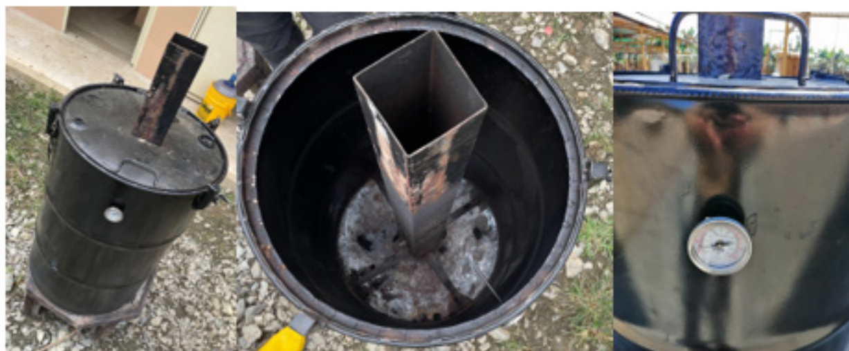
Figura 1. Construcción de reactor pirolítico: A) vista frontal del reactor; B) interior del reactor; C) Termómetro acoplado al reactor.
